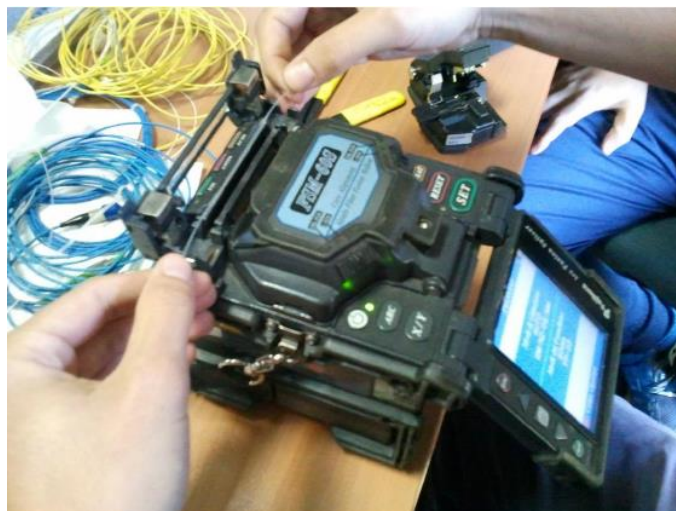
Figura 9. Inserimento del termorestringente.
