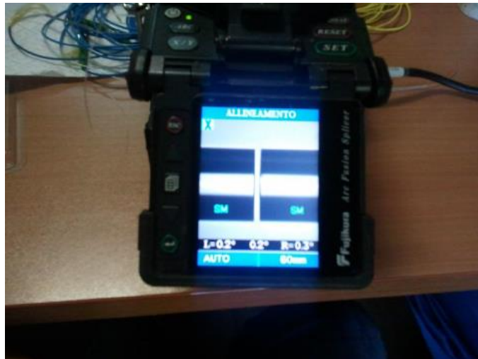
Figura 8. Allineamento delle fibre prima della fusione.
