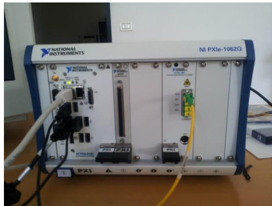
Figura 18. Sistema modulare PXI National Instruments con interrogatore ottico per sensori FBG
