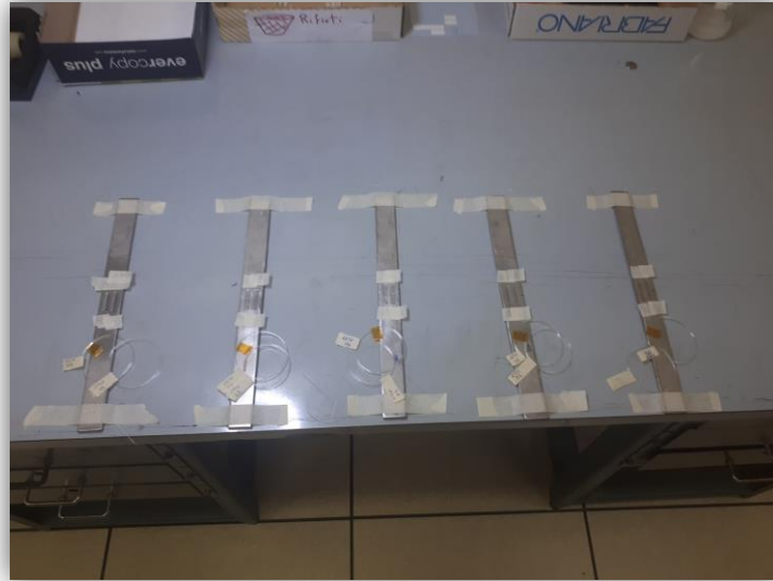
Figura 15. Posizionamento dei sensori durante la fase di polimerizzazione della resina
